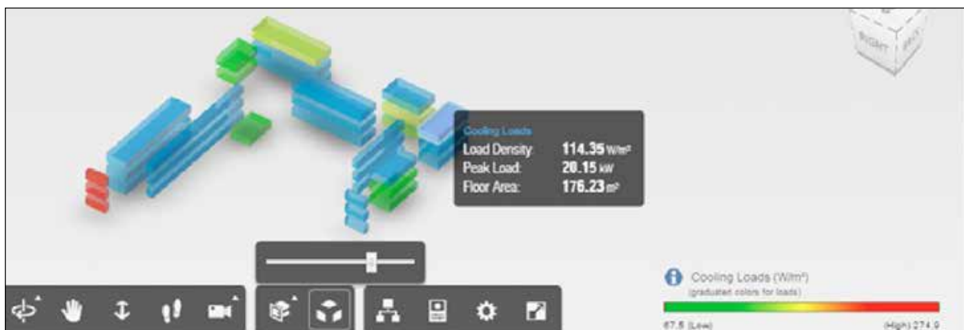
Visualizzazione dei consumi energetici nei singoli blocchi termici dell'edificio
